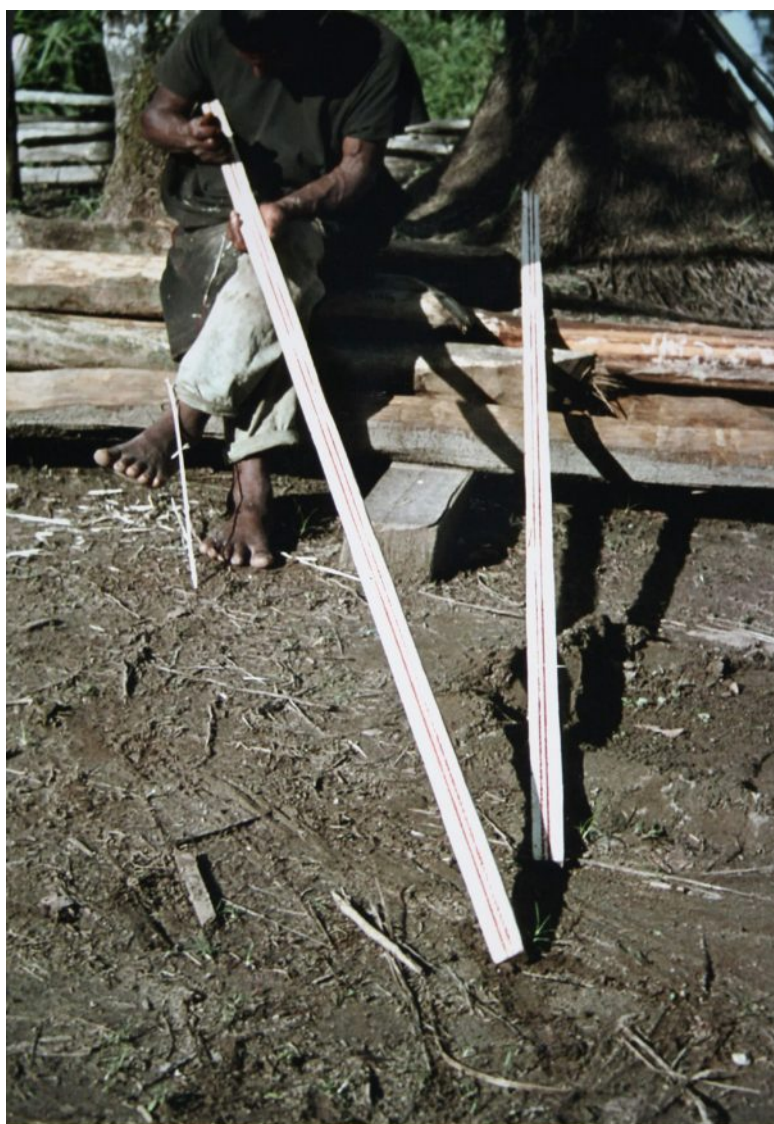
Fot. 4. Cofán. Drążenie tunelu wewnątrz połówek dmuchawki. Fot. B. Malkin, Santa Rosa de Sucumbios 1970 r.
